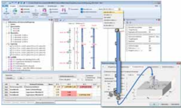
BEST mit Berücksichtigung der Fundamenteinspannung
