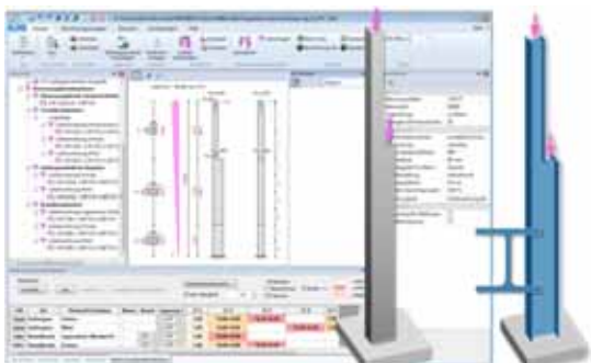
BEST – Kragstütze Industriehalle in Stahlbeton oder Stahl
